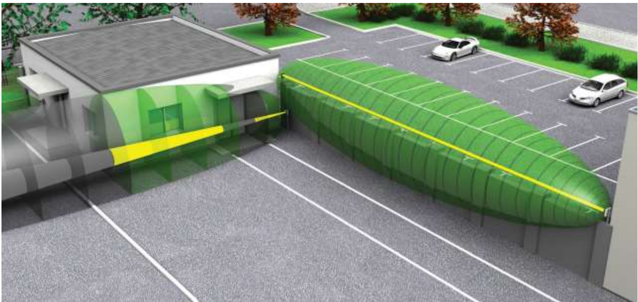
Protection du périmètre à l'aide de la barrière bistatique double technologie MIR-B100 et la barrière monostatique double technologie MIR-M30
